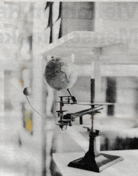
Veranschaulichen: Ein Tellurium erklärt die Bewegungen von Erde und Mond um die Erde mit den Erscheinungen von Tag und Nacht.
